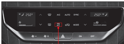
Schalter der hinteren Klimaanlage
